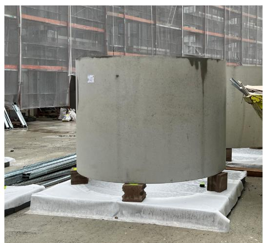
Für eine Wohnhausanlage in Wien, Effenbergplatz wurden 15 Stück Beton-schachthülsen DN 200 cm mit Wandstärke 12 und 15 cm sowie einer Höhe von 160 cm geliefert. Die Schachtringe wurden zusätzlich bewehrt und mit einer Betongüte von mind. C45/55 B7 hergestellt. Das Produkt wird jeweils als Pflanzentrog verwendet. Je Pflanze muss ein definiertes Volumen an Erde im Trog vorhanden sein.
